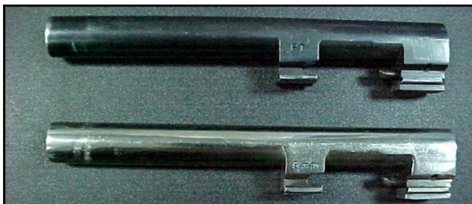
2.1. **CAÑÓN:** Lo constituye un tubo de acero especial, destinada a dar alojamiento, resistir las presiones de la carga de proyección de la munición y/o cartucho y direccionar el proyectil.
