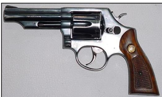
**5.2f. ARMAS DE ACCIÓN SIMPLE.** Arma de fuego que para funcionar requiere al menos en el inicio, de la intervención previa del tirador para armar su mecanismo de disparo debe ser preparada o amartillada.
