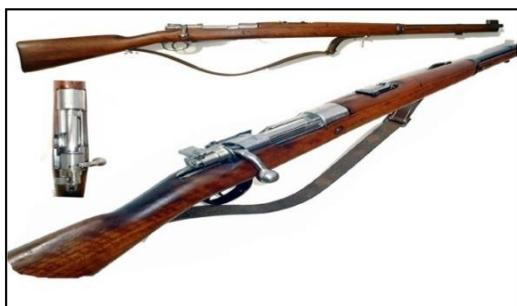
**3.2. REPETICIÓN:** Corresponde a aquellas en las que la munición se almacena en un cargador, siendo necesario accionar un mecanismo manual a fin de subir o alinear la munición de la recámara y realizar el disparo. Debe operarse en forma manual a través de sistemas tales como el de cerrojo, corredera o palanca. Cabe mencionar que los revólveres son a repetición. Ejemplo:
